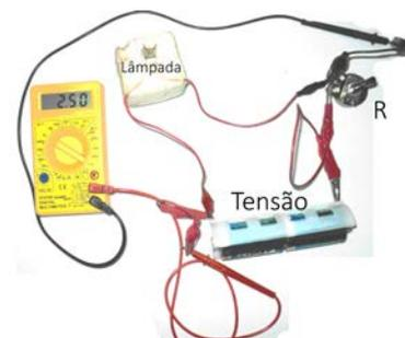
Fig. 20 - Medindo a tensão na função voltímetro.
