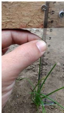
Figura 1: Foto da régua (referencial) utilizada para as medidas de posição das hastes de uma planta (cebolinha) ao longo do tempo.
